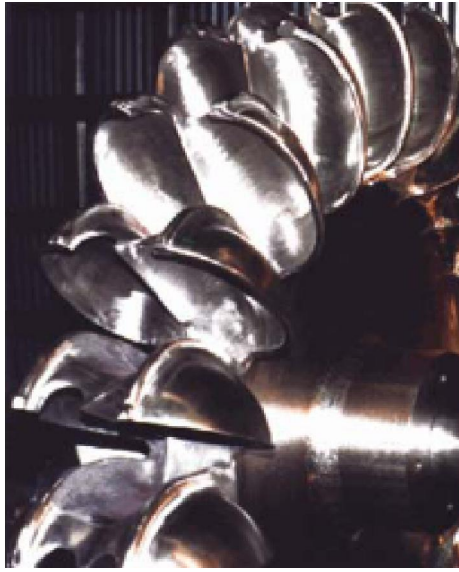
الشكل (10.6) الجزء الدوار في توربين بلتون
